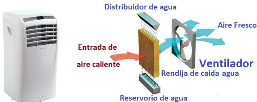
Figura 19. Climatizador evaporativo para refrigeración.
