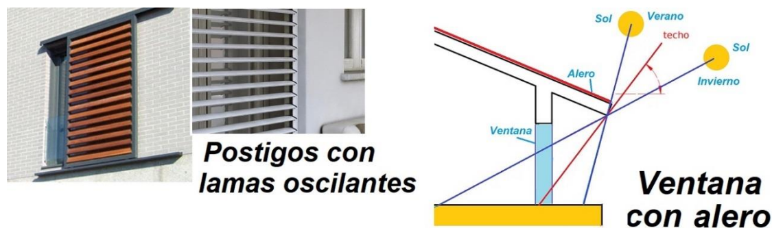
Figura 21. Opciones para reducir la radiación solar.
