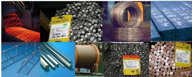
Fabricamos **más de 200 productos** diferentes, pero específicamente en la Planta de Villa Constitución: Palanquillas, Barras Laminadas, Barras Trefilada, Alambres y Alambrón.
