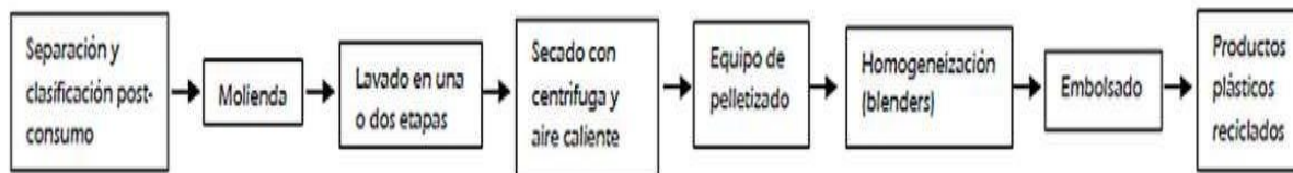
Gráfico 2. Etapas del reciclado mecánico de los plásticos
